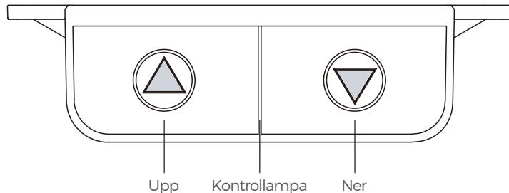
För den första användningen, tryck och håll nere "↓"-knappen tills enheten flyttar sig till det längsta läget och ett pip hörs, sedan kan den höjas och sänkas normalt.
