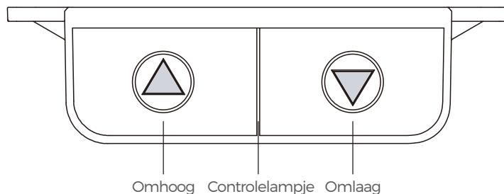
Voor het eerste gebruik houdt de toets "↑" ingedrukt totdat het apparaat naar de laagste positie gaat en er een pieptoon klinkt, waarna het normaal omhoog en omlaag kan worden gebracht.
