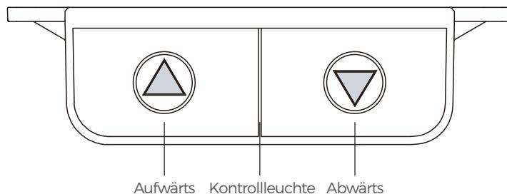
Bei der ersten Benutzung halten Sie die Taste „↑“ gedrückt, bis das Gerät in die unterste Position fährt und ein Signalton ertönt, dann kann es ganz normal angehoben und abgesenkt werden.
