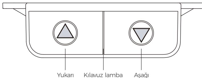
İlk kullanımda, en aşağı konuma gelene kadar "↑" aşağı düğmesine basın. En aşağı pozisyonuna ulaşıldığında bip sesi duyulur. Sonrasında normal olarak yükseltilip alçatılabilir.
